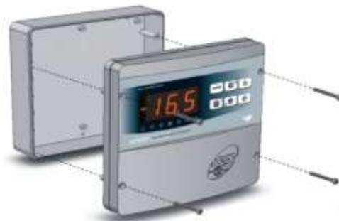
**Abb. 2 :** Benutzen sie die drei vorgefertigten Bohrlöcher, um den Gehäuseboden über drei Schrauben mit angemessener Länge hinsichtlich der Stärke der Wand, an die der Schaltschrank angebracht werden soll, zu befestigen. Setzen sie zwischen jede Befestigungsschraube und dem Gehäuseboden eine Gummischeibe (mitgeliefert).
