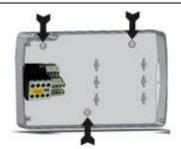
Fig. 7: Riagganciare il frontale al fondo della scatola reinserendo le cerniere nelle apposite sedi e facendole flettere ruotare il tutto di 180° verso il basso per accedere alla scheda elettronica.
