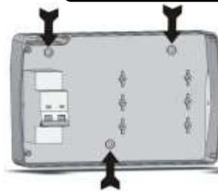
**Fig. 7:** Riagganciare il frontale al fondo della scatola reinserendo le cerniere nelle apposite sedi e facendole flettere ruotare il tutto di 180° verso il basso per accedere alla scheda elettronica.
