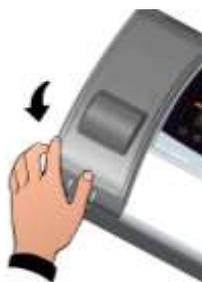
**Fig.4 :** Ouvrez la façade du boîtier en soulevant celui-ci et en faisant coulisser les deux charnières jusqu'en fin de course.
