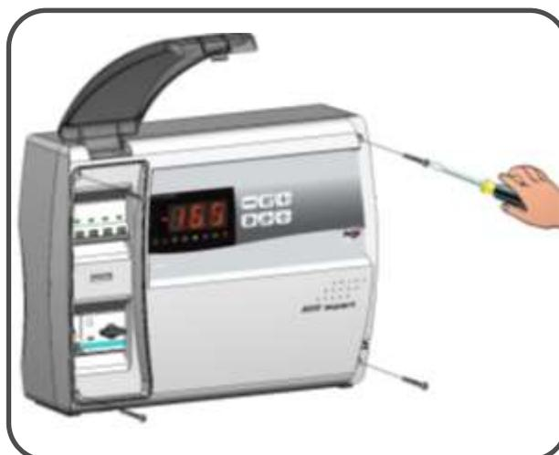
**Fig. 4:** Cierre la puerta transparente de protección del magnetotérmico.
