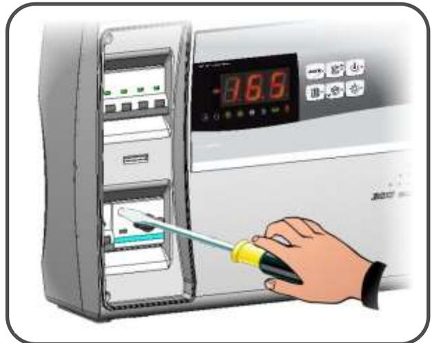
**Fig.17:** Para hacer la calibración, use el tornillo de regulación en la parte frontal del interruptor de circuito del motor.
