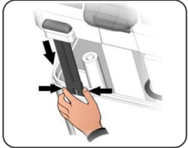
**Fig.13:** Doble las bisagras y gire el panel frontal hacia abajo 180° para obtener acceso dentro del panel y luego vuelva a conectar el conector de la tarjeta electrónica.
