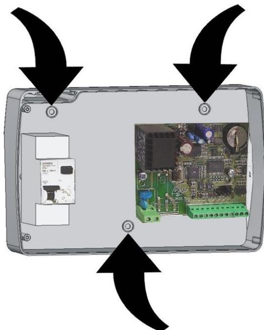
**Fig. 6 :** Utilizzando i tre fori preesistenti fissare il fondo della scatola tramite tre viti di adeguata lunghezza in relazione allo spessore della parete su cui fissare il quadro. Interporre tra ogni vite di fissaggio ed il fondo della scatola una rondella in gomma (fornita).
