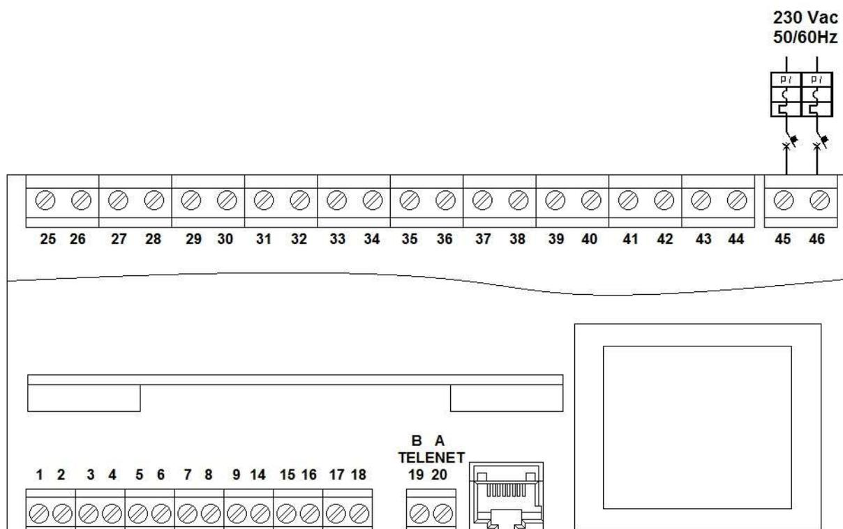
**Sezione alimentazione****45-46** Alimentazione 230VAC 50/60 Hz**Sezione ingressi digitali****3-4** Sonda NTC evaporatore**5-6** Sonda umidità 4-20 mA (0-100Rh%)
