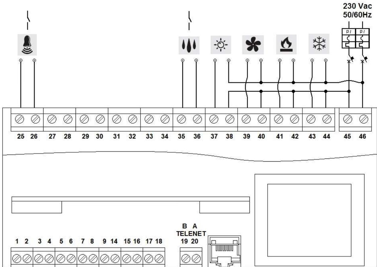
Esempio di collegamento elettrico al PLUS200 EXPERT THR con i contatti in tensione (230VAC) per compressore, caldo, ventilatori, luce e i contatti lasciati privi di tensione per umidificazione e allarme.
