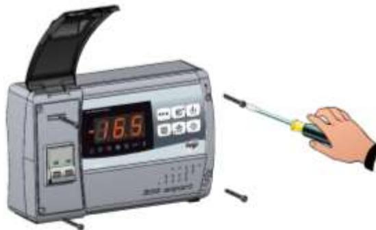
**Fig. 3 :** Fermer la porte transparente de protection du disjoncteur magnétothermique différentiel.
