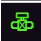
**ICONE ETAT SORTIE EEV Etat de sortie de la vanne électronique EEV (si activée)**
