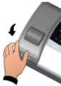
**Fig. 4 :** Ouvrir le devant du boîtier en soulevant et en faisant coulisser les deux charnières jusqu'à la butée d'arrêt.
