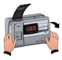
**Fig. 5:** Esercitare una pressione sui lati di ogni singola cerniera per estrarla dalla propria sede e rimuovere completamente il frontale.
