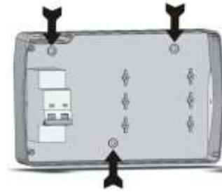
**Abb. 7:** Den Vorderteil des Gehäuses erneut einhängen, indem man die Scharniere in die entsprechenden Aufnahmen einsetzt, sie biegt und das Ganze um 180° nach unten zum Zugang zur Elektronikkarte dreht.
