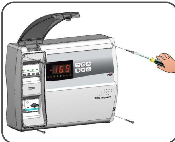
**Fig.20:** Dare tensione di alimentazione al quadro ed effettuare una scrupolosa lettura/programmazione di tutti i parametri impostati.
