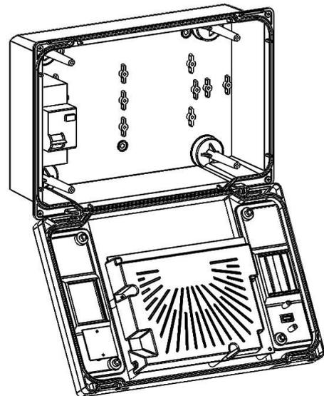
**Fig. 4:** Utilizzando i tre fori preesistenti fissare il fondo della scatola tramite tre viti di adeguata lunghezza in relazione allo spessore della parete su cui fissare il quadro. Interporre tra ogni vite di fissaggio ed il fondo della scatola una rondella in gomma (fornita). Rimontare quindi la batteria (se presente).
