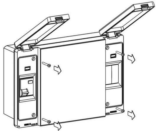
**Fig. 3:** Aprire il frontale della scatola sollevandolo e facendo scorrere le due cerniere fino a fine corsa. Flettere le cerniere e ruotare il frontale di 180° verso il basso per accedere all'interno del quadro.
