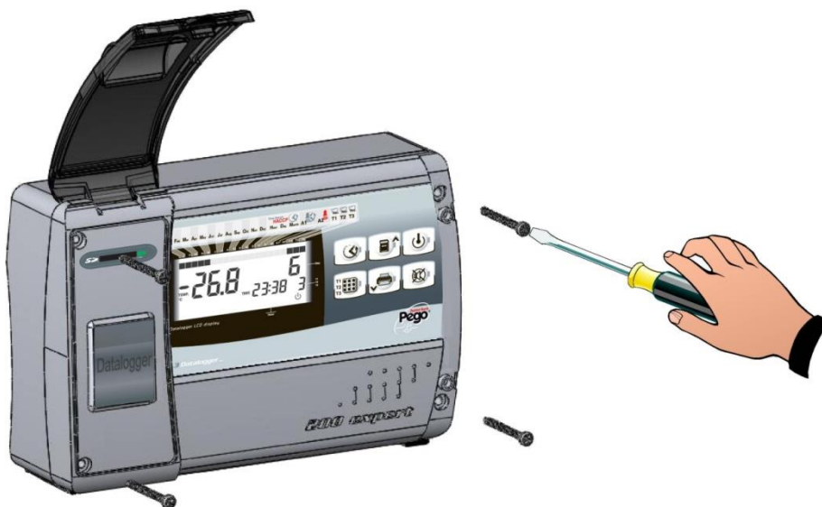
Fig. 2: Dévisser les 4 vis de fixation du frontal du boîtier.
